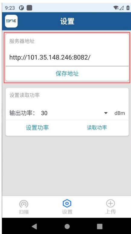
输出功率设置，输出功率用于控制读取距离，功率越高，读取距离越远，反之功率越低，读取距离越近。功率设置范围：1~30 dBm。
